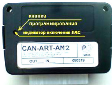
Рис.2. Кнопка и индикатор программирования
