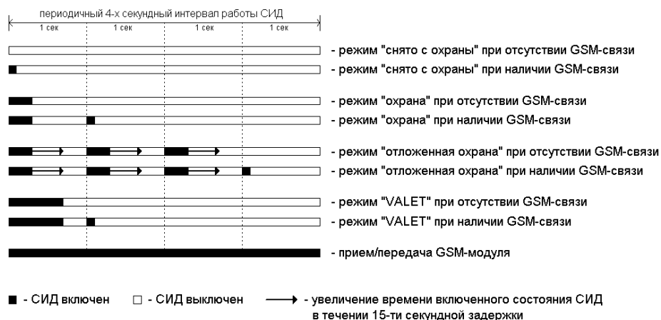
Рис. 2. Индикация СИД режимов работы системы
